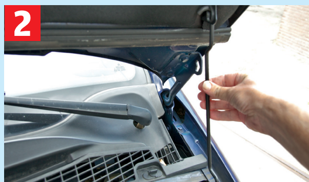
2 Zet de motorkap goed vast met de houder.
