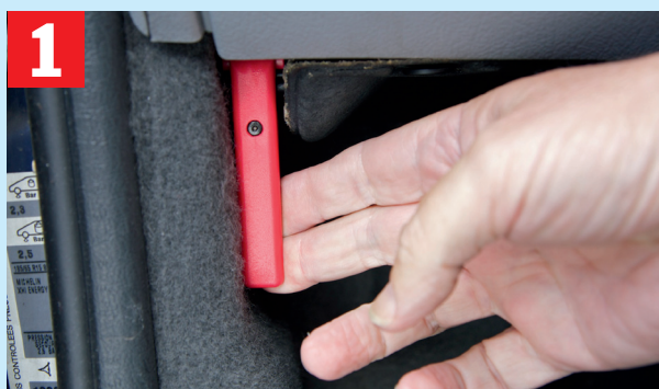
1 Open de motorkap. De hendel hiervan zit meestal links onder het dashboard. Zo niet, raadpleeg dan het instructieboekje.
