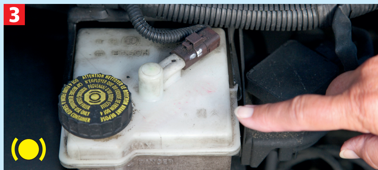
3 Zoek het reservoir van de remvloeistof. Dat heeft een dop waarop vaak het symbool staat dat u linksonder op de foto ziet.
